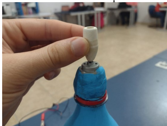
Imagem 3 – Encaixe da borracha ao motor como suporte maleável ao palito de churrasco.
