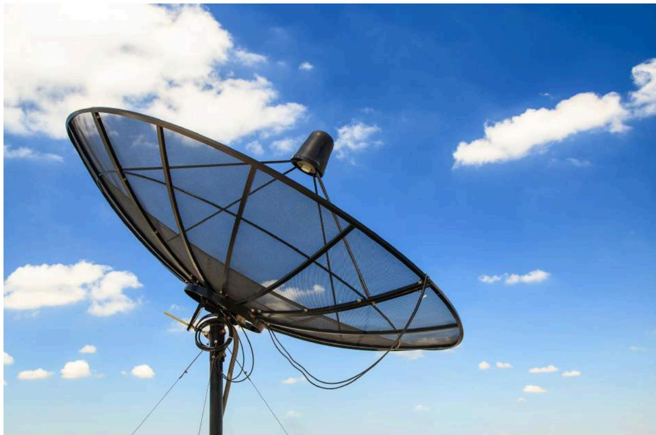
Uma antena parabólica é formada por uma superfície parabólica e um receptor de ondas colocado no foco dessa superfície. Quando a antena é orientada em direção a um objeto distante, como um satélite, por exemplo, todas as ondas que chega à sua superfície são refletidas e se concentram nesse foco.
