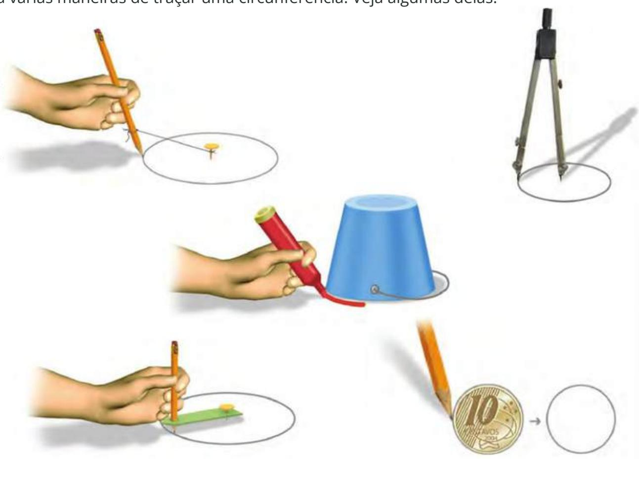
O compasso é o instrumento ideal para traçar circunferências. Usando a ponta seca, fixamos um ponto do plano,  $O$ , que será o centro da circunferência. A abertura do compasso determina a medida do raio  $r$ .
