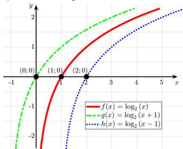
Figura 5: Deslocamento horizontal por influência do coeficiente  $c$ .
