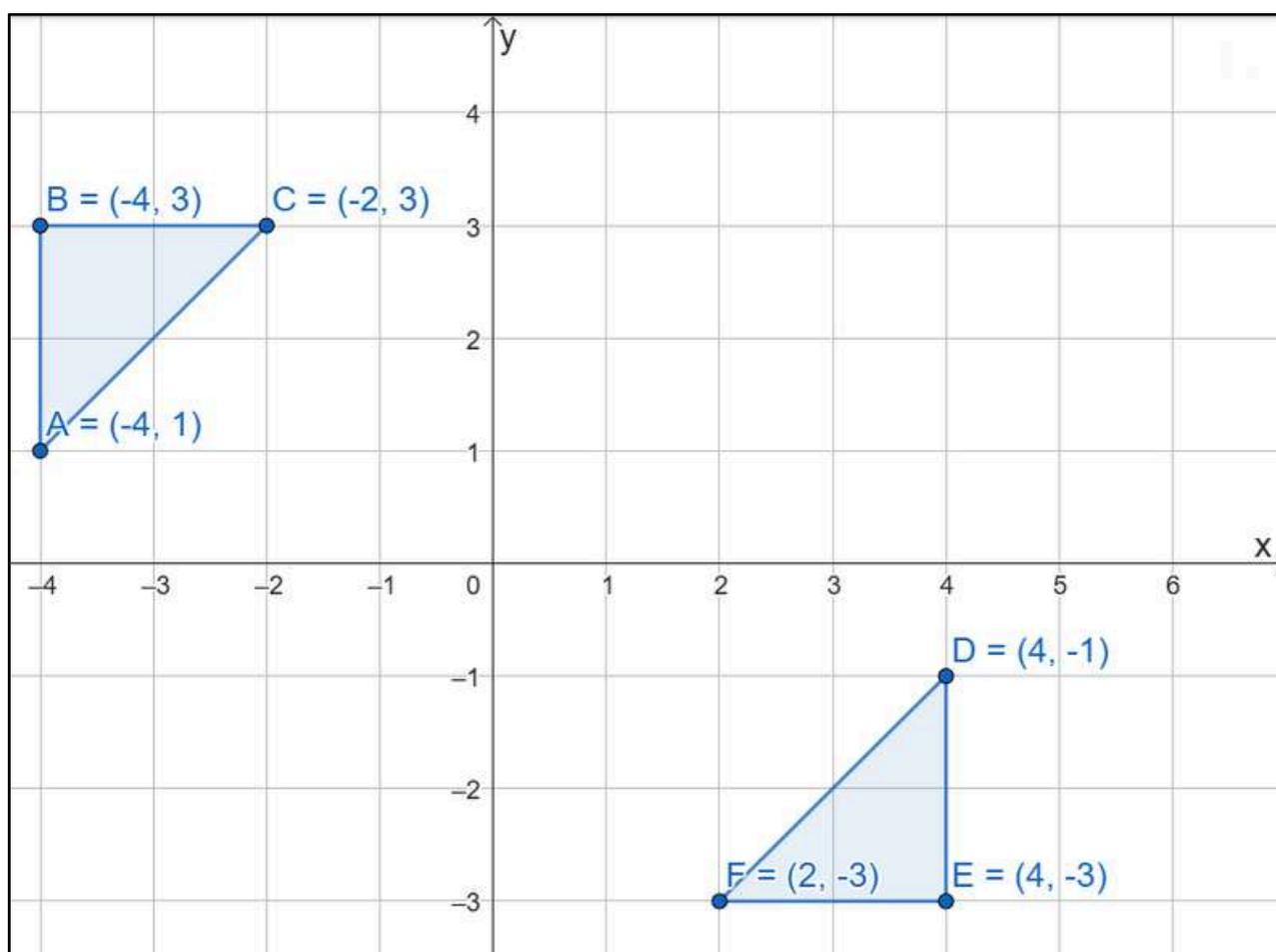
Podemos observar que os pontos do triângulo DEF são obtidos multiplicando as coordenadas do triângulo ABC por  $-1$ . Isso significa que houve uma **reflexão** na origem  $(0,0)$ , mudando os sinais de X e Y. Isso confirma que a transformação foi uma rotação de  $180^\circ$ .
